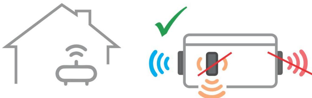
Si le spa est situé dans une fosse ou sous une terrasse, placez le module au-dessus du sol dans une zone protégée contre les intempéries avec une ligne de vue vers le routeur.
