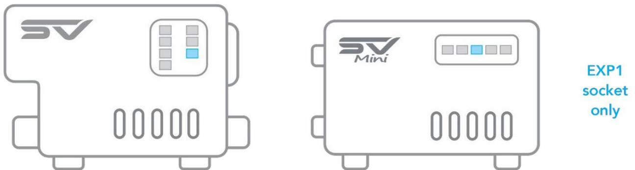
Hinweis: Wenn die EXP1-Buchse bereits belegt ist, entfernen Sie das Kabel von EXP1 und schließen Sie es an die LOOP-Buchse im Modul an. Stellen Sie sicher, dass das Datenkabel von SmartLink direkt an die EXP1-Buchse angeschlossen wird
