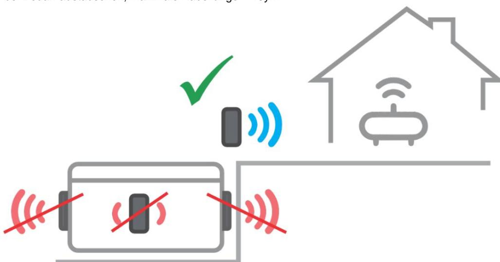
Schritt 2: Das Modul muss vertikal ausgerichtet sein, um eine ausreichende Signalstärke zu empfangen und das WiFi-Logo oben zu haben, damit der Wasserschutz gewährleistet bleibt.
